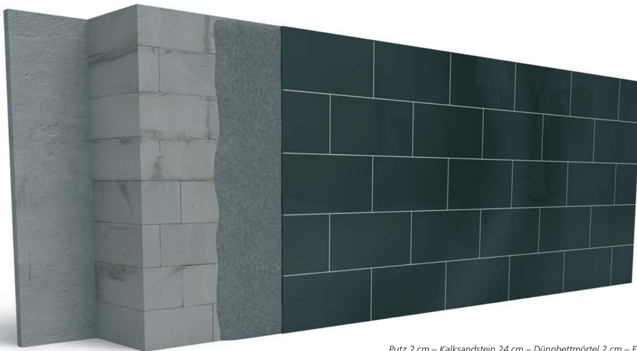
Putz 2 cm – Kalksandstein 24 cm – Dünnbettmörtel 2 cm – Fliese 1 cm Bis zu 74 % Energieeinsparpotential: Mit wedi Bauplatte mit einer Stärke von 80 mm
